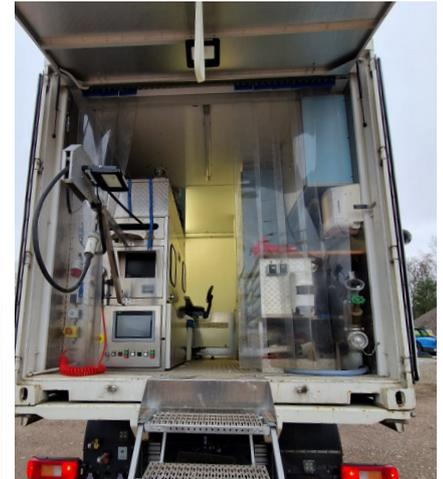
**SPECIALS: DOUBLE** Alimentation électrique via les batteries **supplémentaires**, Régulation électrique de la pression intérieure Inliner KASRO, automatique et système de contrôle de pression KASRO
